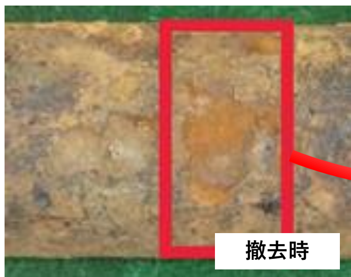
腐食性土壌地区の管の腐食状況：S53年布設管（44年経過）
