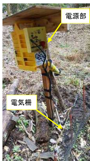
写真 3.4-5 移設地 A における電気柵の設置状況 (R4 年 3 月 21 日撮影)
