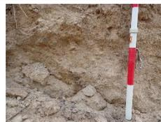
砂礫。直径 3cm 程度の垂円礫を含む砂礫。基質部は粗砂より構成される。
