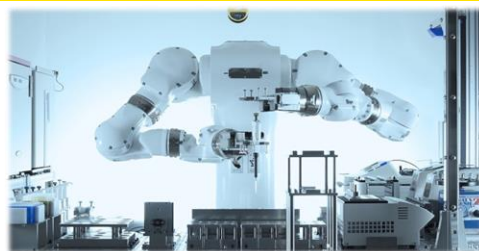
写真65 汎用ヒト型ロボットLabDroid「まほろ」
