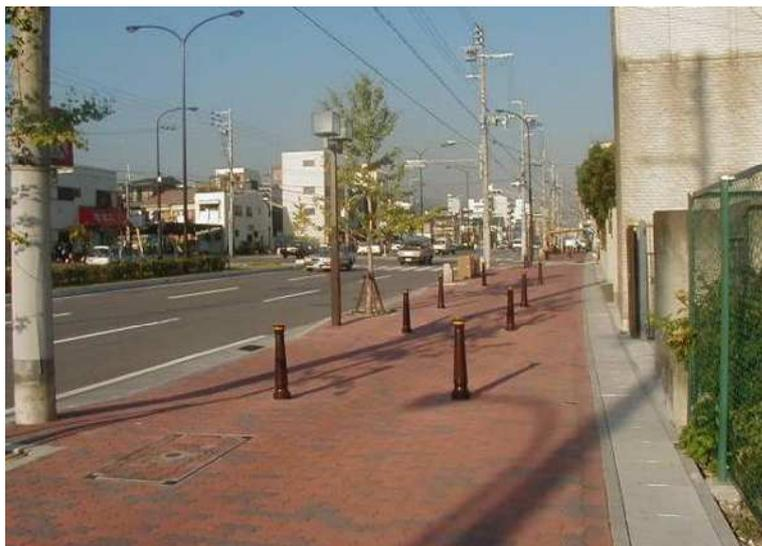
写真2-3-4 横断方向へのボラード等の設置例
